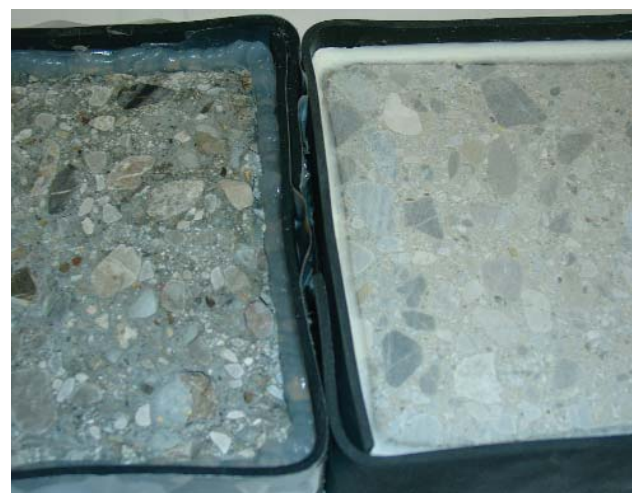
Vor (rechts) und nach (links) Frostprüfung.
