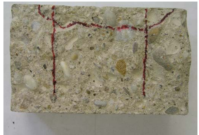
Die Abbildung zeigt den Prüfkörper nach der Wasserundurchlässigkeitsprüfung
