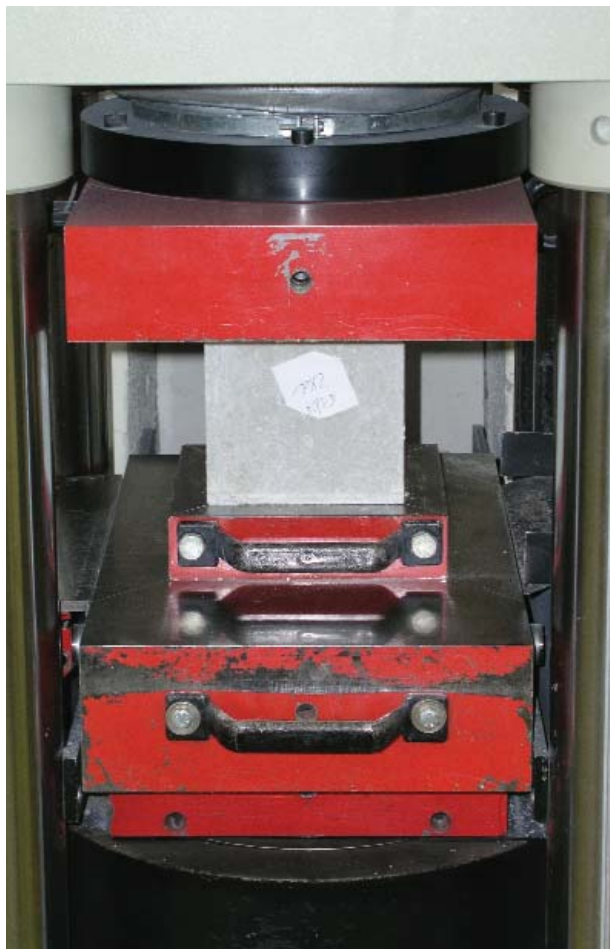
Druckfestigkeitsprüfung gemäß ON B 3303
